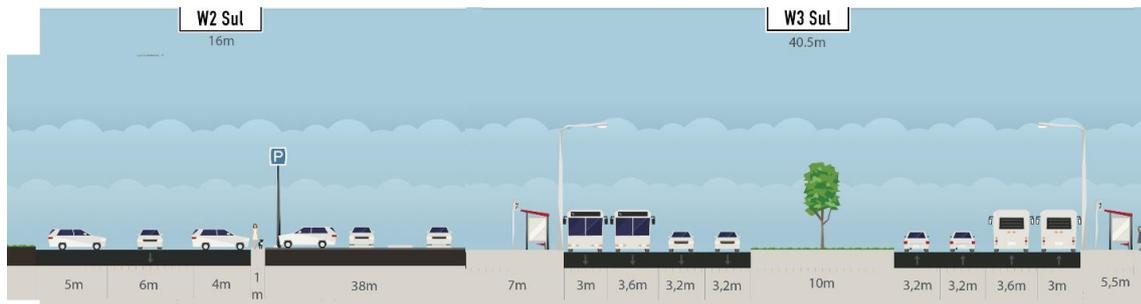
Figura 9: Corte 01 –Paradas de ônibus e estacionamentos. Autoria própria. 2015
